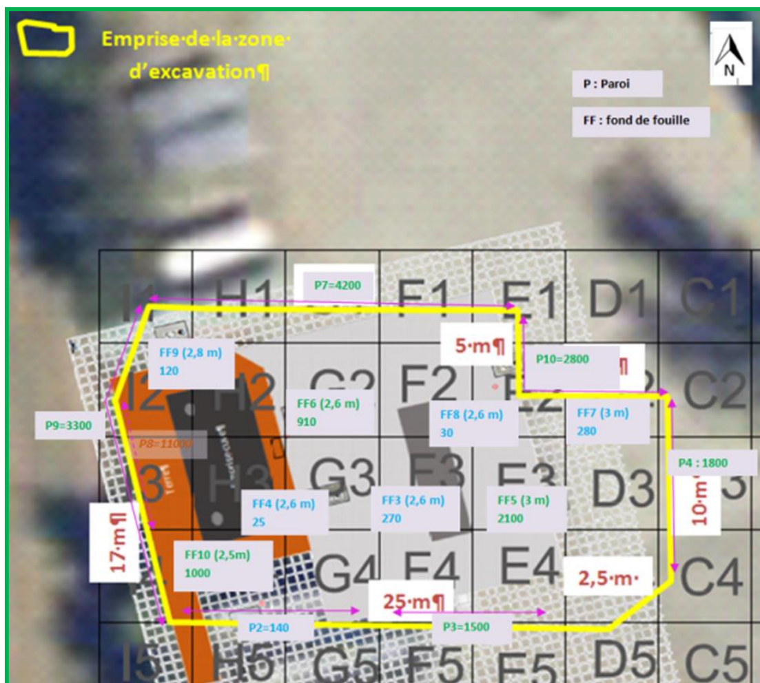
Figure 4 : Concentrations résiduelles dans les sols au droit de la zone réhabilitée (station de service)
