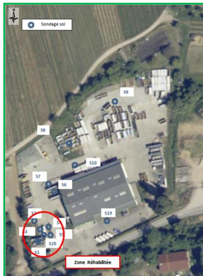
Figure 9 : Sondages réalisés dans les sols au droit du site
